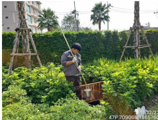
คุณภาพน้ำทิ้งก่อนระบายออกสู่ภายนอกโครงการหลังการบำบัด (บ่อตรวจคุณภาพน้ำพร้อมตะแกรงดักขยะ)
